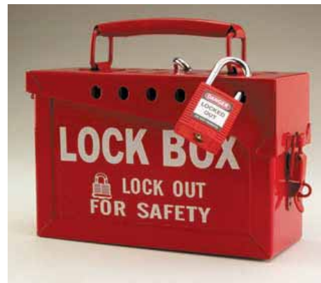
Рис. №5 Пока все члены бригады не снимут свои замки с группового блокировочного бокса, никто не сможет снять блокиратор с оборудования
