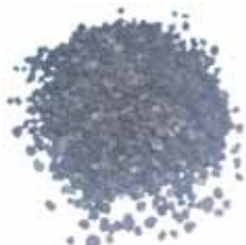
Рис. №1. Активированный уголь марки SGL 8x18 (размер частиц 1,00 – 2,36 мм)
