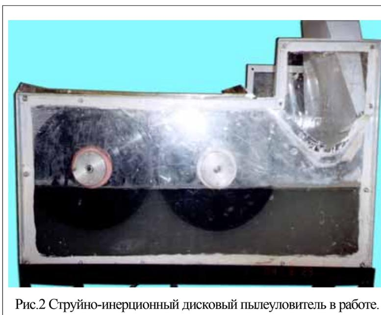
Рис.2 Струйно-инерционный дисковый пылеуловитель в работе.
