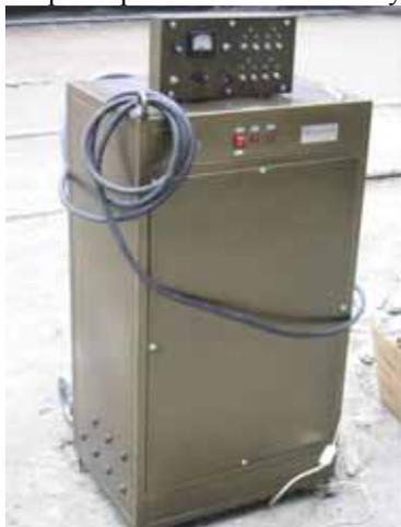
Рис. №1. Источник импульсного электропитания с пультом управления
