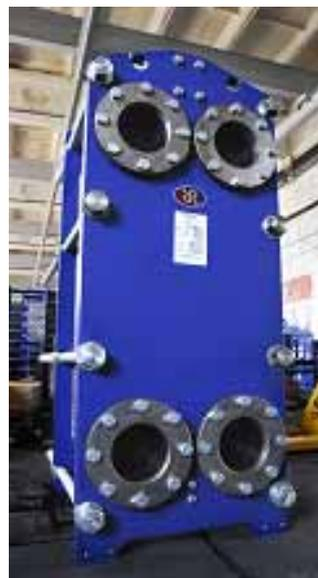
Рис. №2. Пластинчатый теплообменник
