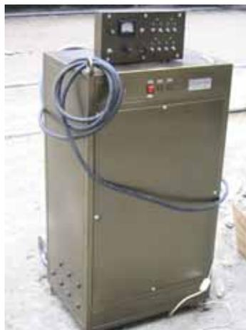
*Рис. 4. Блок управления АСО в бункерной зоне*
