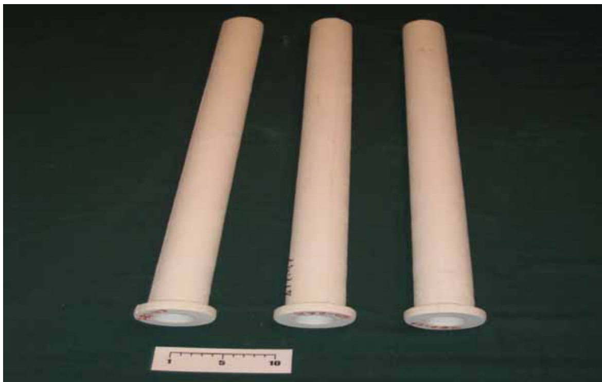
Рис. 1. Фильтрующие элементы из пористой проницаемой керамики
