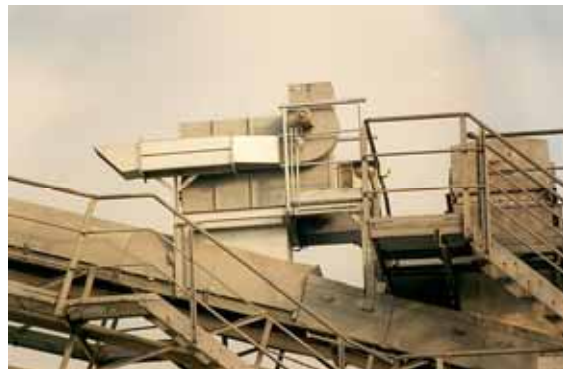
Рис. 7. Фильтр INFASTAUB на месте пересыпки.
