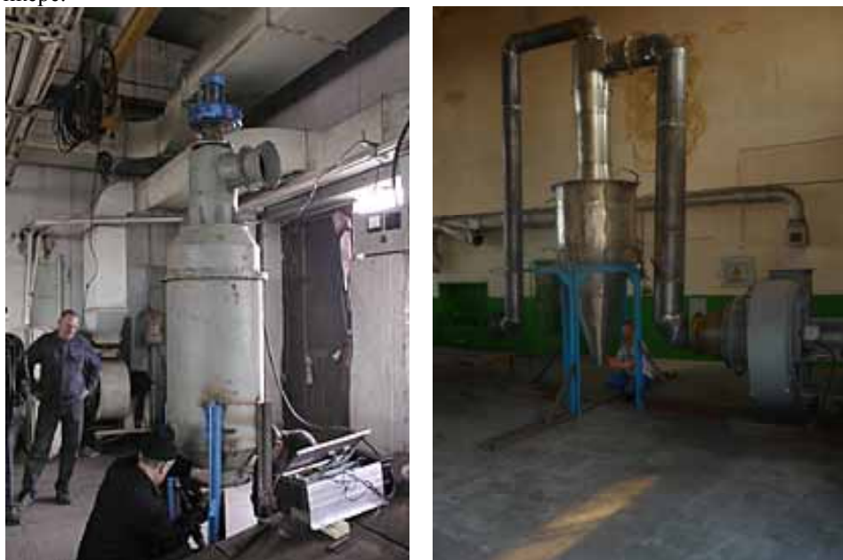
Рис. № 6. Фото полупромышленной и промышленная установок инерционно-вакуумного пылеуловителя.
