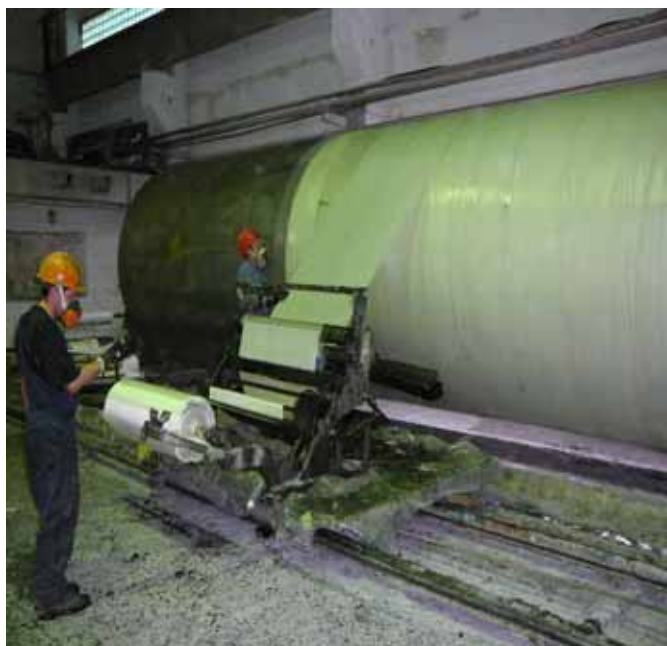
Фото № 3. Изготовление царг из стеклопластика.
