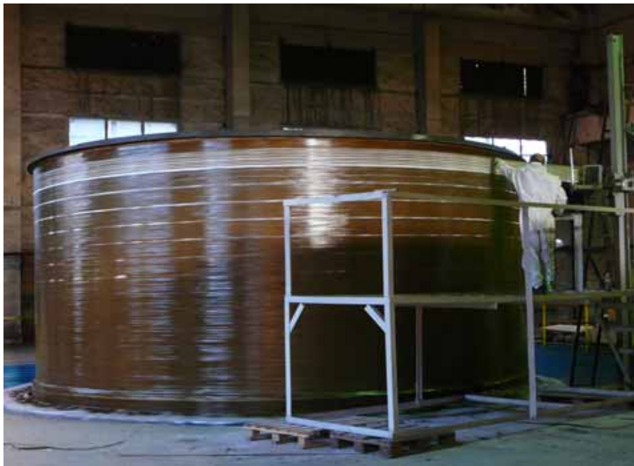
Фото № 5. Процесс намотки корпуса крупногабаритного оборудования на монтажной площадке.
