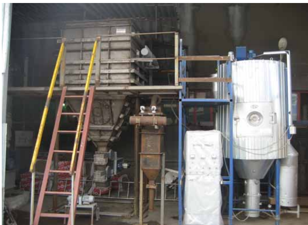
Рис. 2. Фильтровальная установка с фильтрующими элементами из пористой проницаемой керамики
