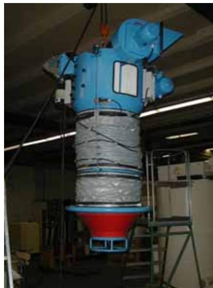
Рис. 9. Станция погрузки сыпучих материалов INFA-POWTRON.
