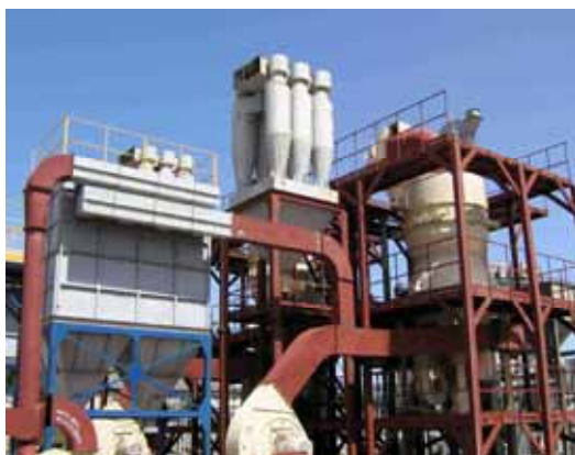
Рис. №1 рукавный фильтр ФРИ-С-008-166 (ОС) за инерционной мельницей.
