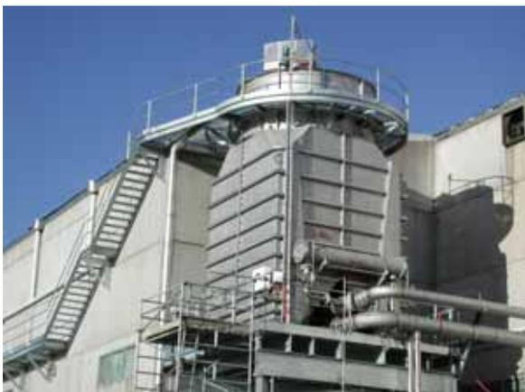
Multimegacell - MMCV – специальные ламельные флотаторы с производительностью от 1000м<sup>3</sup>/час до 12 000м<sup>3</sup>/час. Это оборудование для высоких и сверх высоких производительностей.
