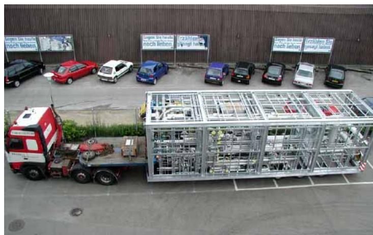
Рис. 3. Технологический модуль в процессе сборки в производственном цеху, а также при подготовке к транспортировке.
