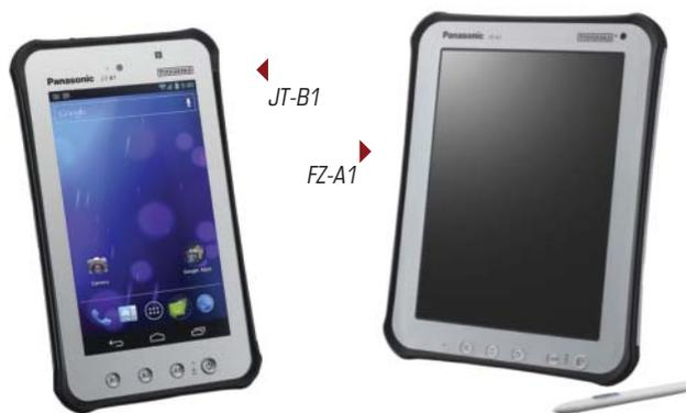
Новая модель Toughpad JT-B1 является первым защищённым планшетом Panasonic с диагональю экрана 7 дюймов, управляемым ОС Android. Его эргономичная конструкция рассчитана на управление одной рукой и применение в полевых условиях компаниями, работающими в коммунальной сфере, общественном транспорте, логистике, для учёта средств, а также силами охраны правопорядка.
