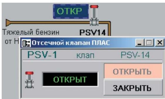
Рис. 4. Управление отсечным клапаном
