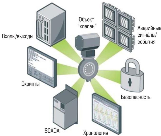
Рис. 1. Шаблон объекта содержит важную информацию об аварийных сигналах, событиях, безопасности, хронологии, SCADA, сценариях, входах и выходах
