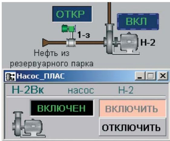
Рис. 3. Управление насосом
