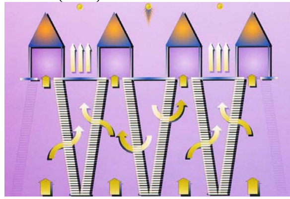
Рис. 7 Схема работы BOU AAF AS. Импульсная очистка фильтрующей панели.
