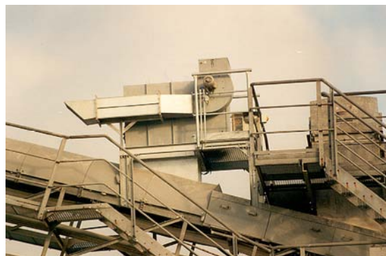
Рис. 7. Фильтр INFASTAUB на месте пересыпки.
