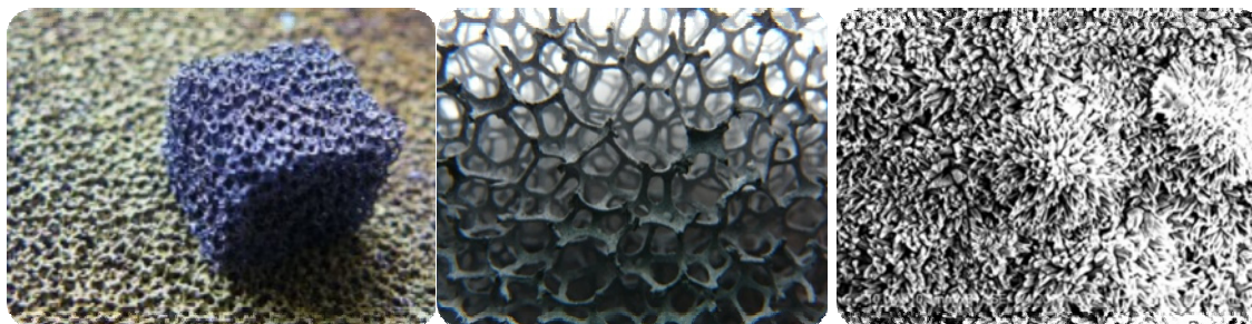
Рис. 1 Внешний вид (а), сетчато-ячеистая структура (б) и каталитическое покрытие (в) катализаторов.
