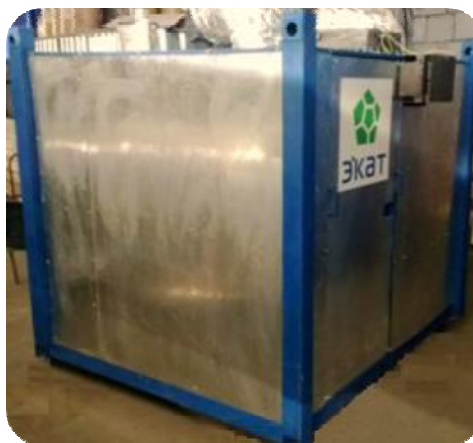
Рис. 2(б) Общий вид термokatалитической установки очистки газовых выбросов
