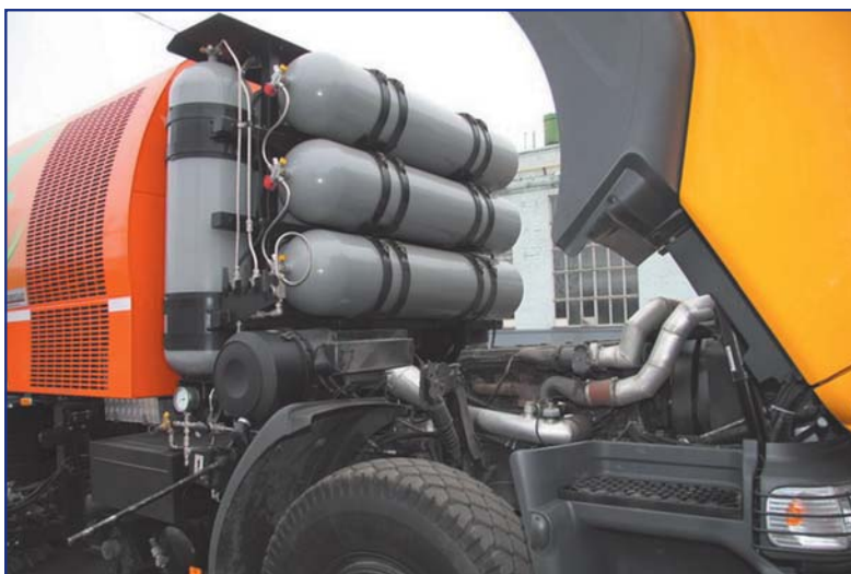
Под кабиной — газовый двигатель Mercedes-Benz мощностью 279 л.с., а за ней — баллоны с метаном
