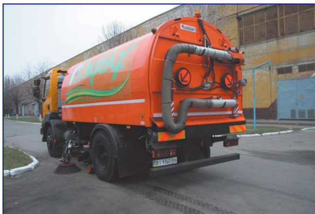
Задний всасывающий шланг длиной 4000 мм, диаметром 250 мм
