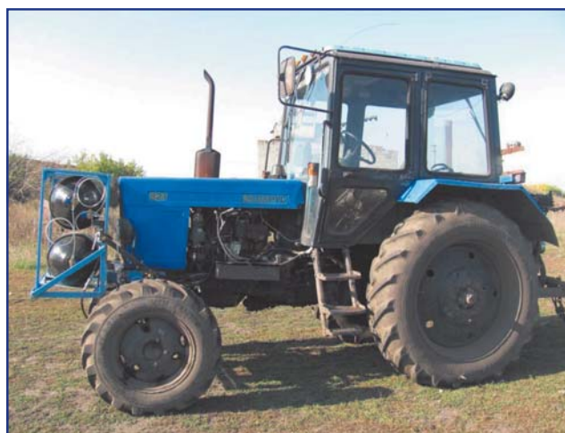
Рис. 11. Внешний вид газодизельного трактора МТЗ-82.1 (на капоте трактора — в его левой части установлен газорегулирующий модуль с баллонами с природным газом)
