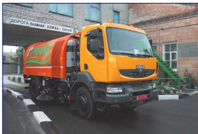
Кабину для газового КРАЗа позаимствовали у известного французского грузовика Renault Kerax
