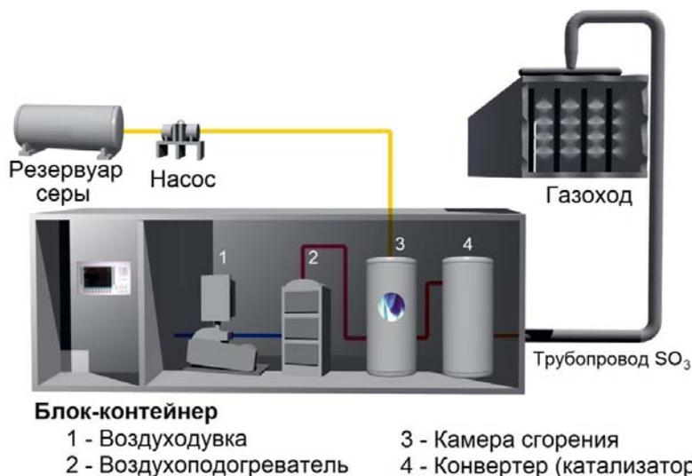
Рис.2. Схема размещения оборудования для кондиционирования дымовых газов
