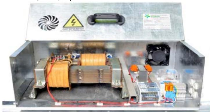
Газоконверторы STRADA FACTORY успешно применяются в системах вытяжной вентиляции, когда газо-воздушная смесь не загрязнена значительными концентрациями пыли или других твердых частиц, аэрозолей, смол, пара, волокон.
