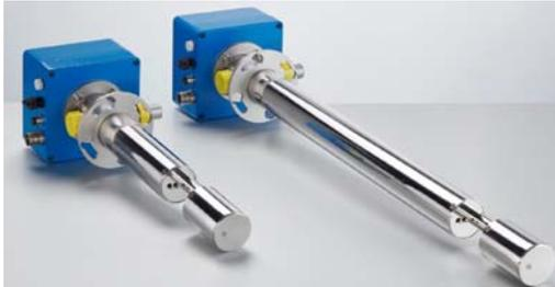
Преемник прибора D-R 800. Реализует метод прямого рассеяния света. Может успешно применяться для газоходов с малым диаметром, а также для толстостенных газоходов. Устанавливается только на одной стороне трубы. Имеет шкаф электропитания с интегрированной установкой продувки воздухом. Может управляться с помощью блока D-ISC 100
