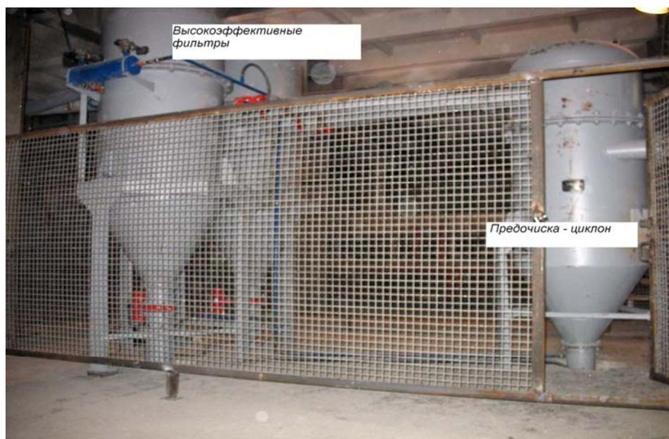
При этом продукт не выбрасывается а возвращается в производственный цикл. Станция позволяет обслуживать практически всё предприятие от отметки «минус 5 метров» до отметки «плюс 39 метров».
