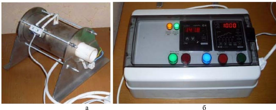
Рис.5. Установка для локализации радионуклидов  $^{137}\text{Cs}$  в процессе изготовления источников ионизирующего излучения: а – мини-печь сопротивления со сменными картриджными фильтрэлементами, б – приборный бокс.
