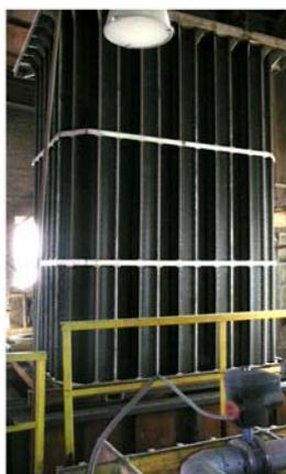
Рис.4. Моноблочная осадительная система
