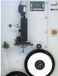
Применяется для влажных газов, доменного дутьевого газа. Возможно дополнительный анализ содержания тяжелых металлов. Опционально возможно применения зонда с разбавлением пробы для высоких концентраций пыли или после влажных скрубберов. Позволяет производить измерения в малодоступных вытяжных трубах малого диаметра.
