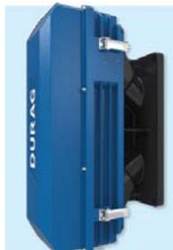
В данном оборудовании применяется метод обратного рассеяния и реализуются измерения малых концентраций сажи и пыли. Имеется функция автотестирования системы и коррекции измеряемых величин, а также самокалибровки каждые 4 часа.
