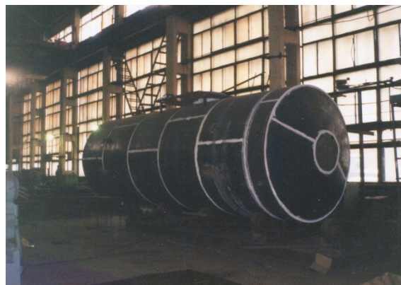
Цистерна под соляную кислоту защищенная ламинатом «Ремохлор»
