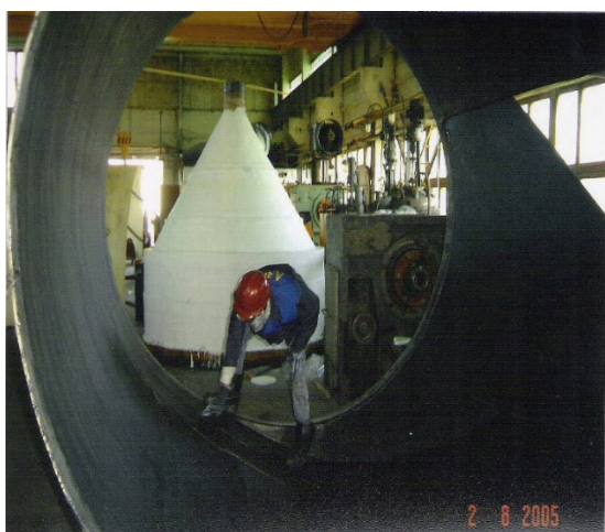
Защита полиэфирной трубы ламинатом «Ремохлор»
